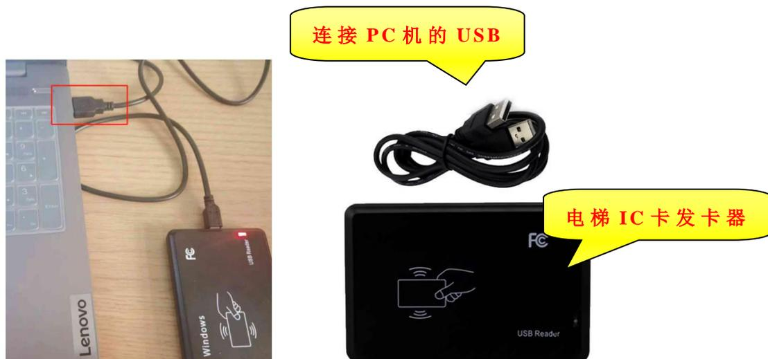
图 2.8 发卡器连接电脑界面
